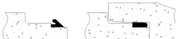
El empaque satisface y/o excede los requerimientos de Propiedades físicas de ASTM C-443 y NMX-C-412
